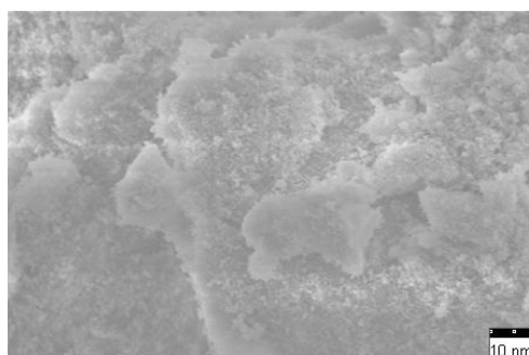
Fig.3.4.6. Imagine SEM a Pd-Sn/Al 2 O 3
