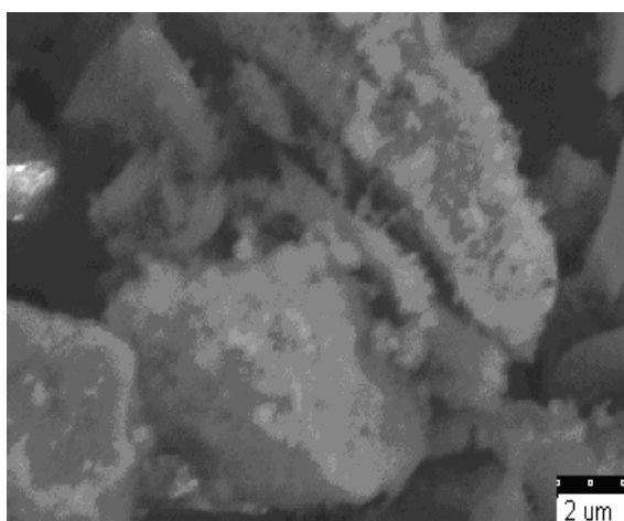
Fig.4.4.3. Imaginea SEM pentru \text{NiFe}_2\text{O}_4 , calcinat la 600^\circ\text{C}/2\text{h}
