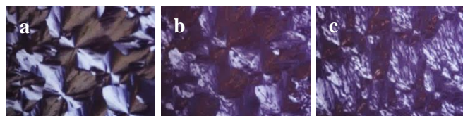
Figura 1.20. Modificarea texturii optice a complexului 6c la 180°C (a), 120°C (b) și 60°C (c) la răcirea din fază izotropă
