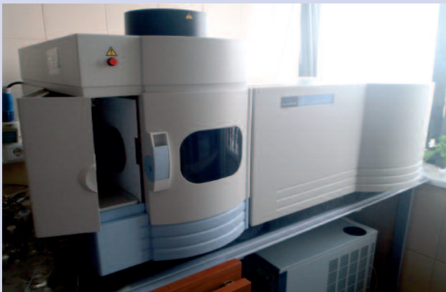
Fig.1. Spectrometru de emisie optica cu plasma cuplata inductiv.
