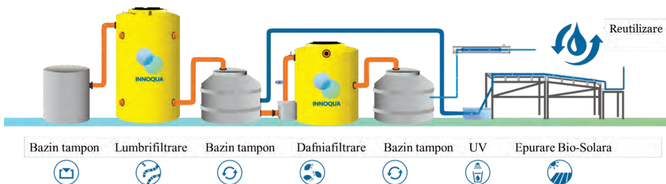
Fig. 8. Reprezentare schematică a configurației sistemului INNOQUA instalat în India
