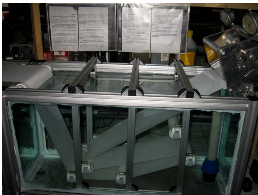
Fig. 3.7. Începerea procesului de realizare a membranelor compozite (peliculizarea soluției polimerice și preformarea membranei)
