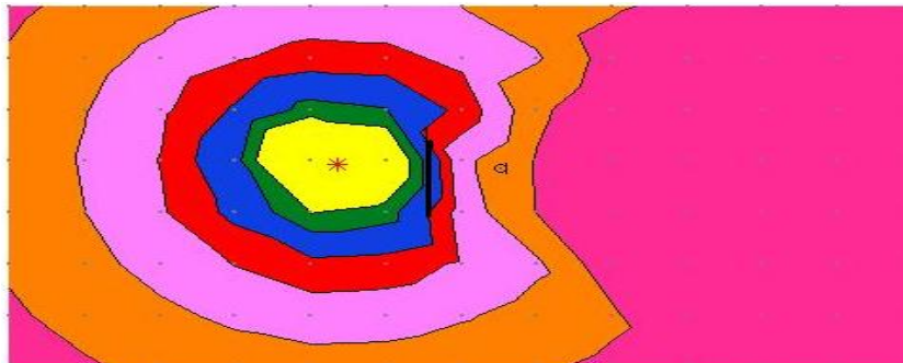
Figura 6.36.B Harta de zgomot reprezentând experimentul din camera surdă la momentul interpunerii barierei atenuatoare
