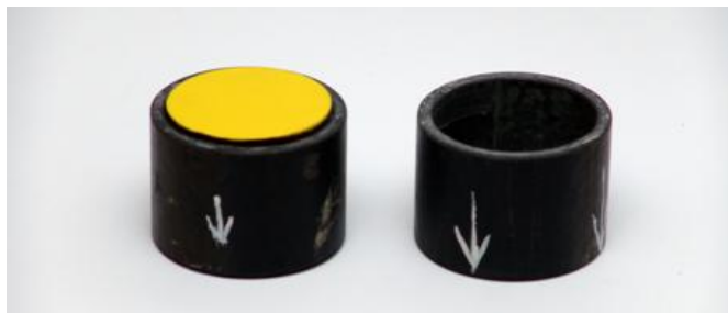
Figura 4.4. Matrița utilizată la obținerea probelor
