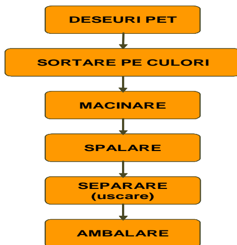
Figura 4.2. Flux tehnologic la obținerea „fulgilor” PET
