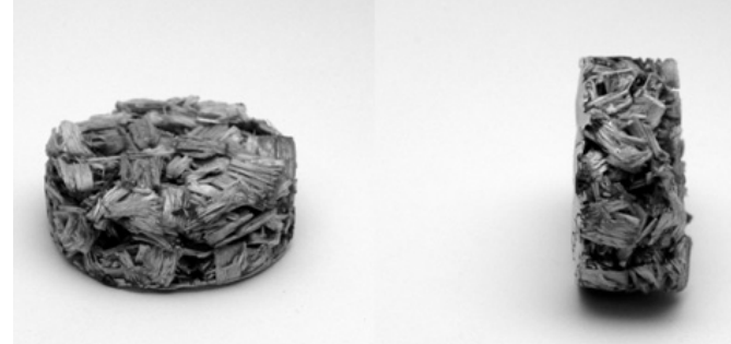
Fig.4.b - P2 – Formaldehyde resin – wood waste / P2 – Rășină formaldehidică – deșeu lemn.
