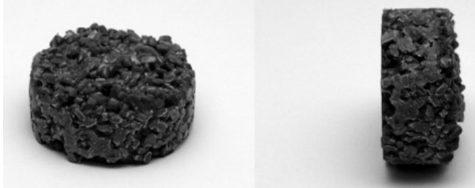
Fig.4.c - P3 – Formaldehyde resin – polypropylene waste / P3 – Rășină formaldehidică – deșeu polipropilenă.
