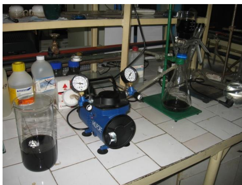
Figura 4.2 Instalația de microfiltrare Millipore tip ansamblu de filtrare
