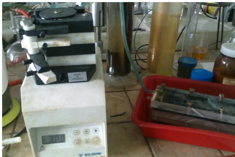
Figura 3.9 Celula de studiu pentru măsurarea potențialului de curgere
