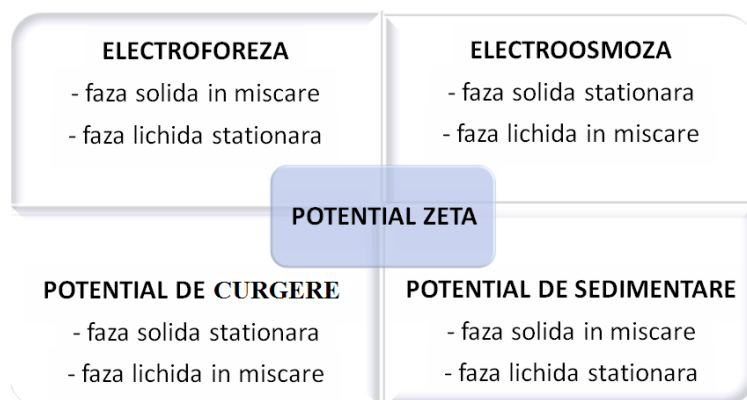
Figura 3.7 Efectele electrocinetice induse de potențialul Zeta
