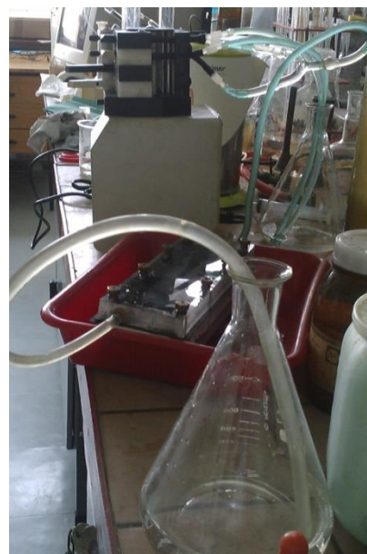
Figura 3.9 Celula de studiu pentru măsurarea potențialului de curgere
