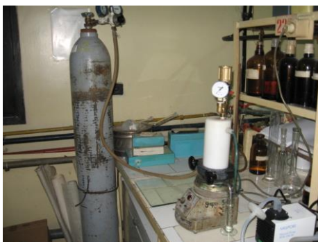
Figura 4.3 Instalația de MF/UF tip “celulă Berghoff”
